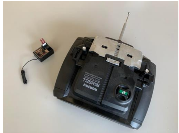
市售 3 通道 27MHz 板型遙控收發器
